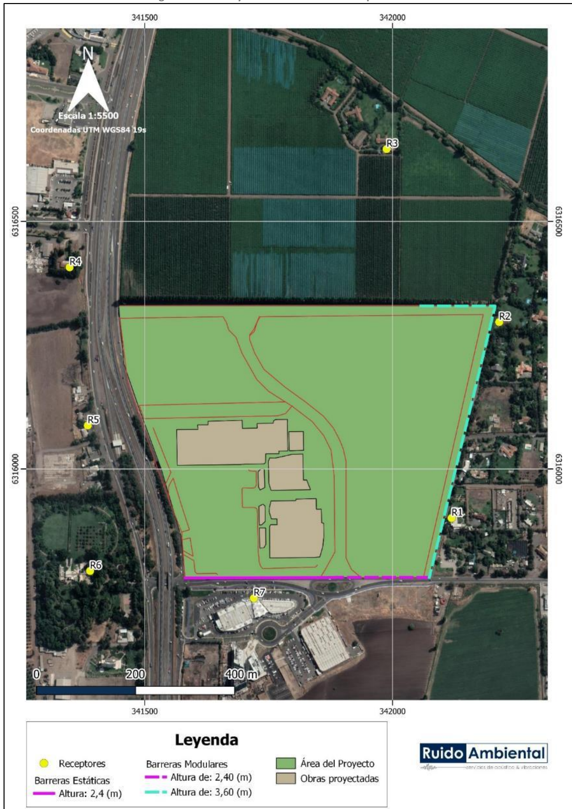
Figura 31. Altura y ubicación de los cierres perimetrales
